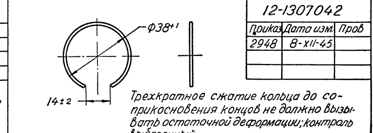
КОЛЬЦО СТОПОРНОЕ САЛЬНИКА КРЫЛЬЧАТКИ ВОДЯНОГО НАСОСА
